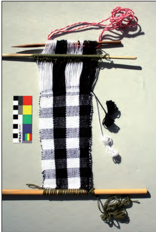
Fig. 14a. Telar moderno simple con lizos fijos y la elaboración de tela de faz de urdimbre y trama equilibrada.
