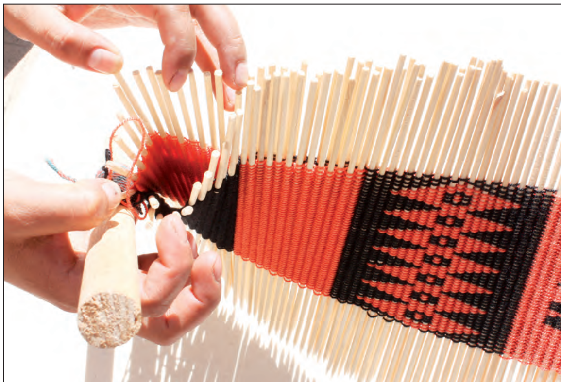
Fig. 244b. Maqueta de la técnica de doble tela simple, urdida a 2, y con manos abriendo el bolsón entre las dos caras.
