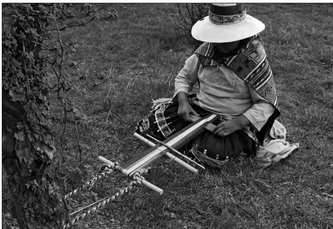
Fig. 8. Telar simple de cintura (La Paz, Bolivia).
